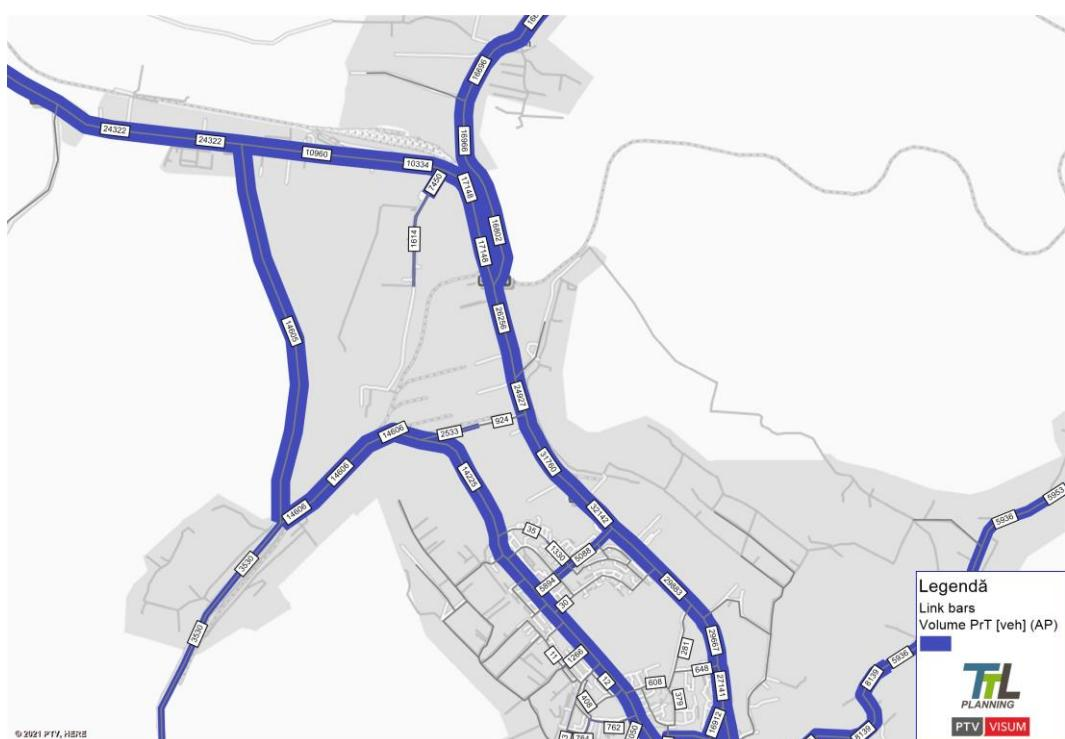
**FIGURA 136 FLUXURI RUTIERE DE TRAFIC– DIFERENȚĂ CU / FARA PROIECT - PROGNOZĂ 2027**
