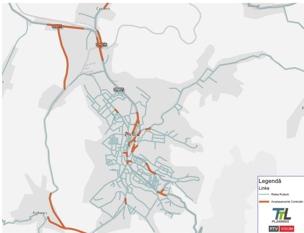
Rezultatele calibrării demonstrează o corelație bună între volumele de trafic modelate și cele contorizate evidențiind că 100% din fluxurile modelate sunt în marja de diferență de 15% față de fluxurile observate, pentru autoturisme și biciclete, 97% pentru Vehicule Ușoare de Marfă și 87% pentru Vehiculele Grele de Marfă, cu o abatere pătratică medie ( $R^2$ ) de peste 0.96 pentru toate modurile de transport.
